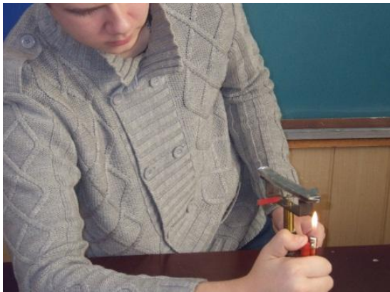
Мал.1. Термопара: мідь-вісмут з магнітною стрілкою
