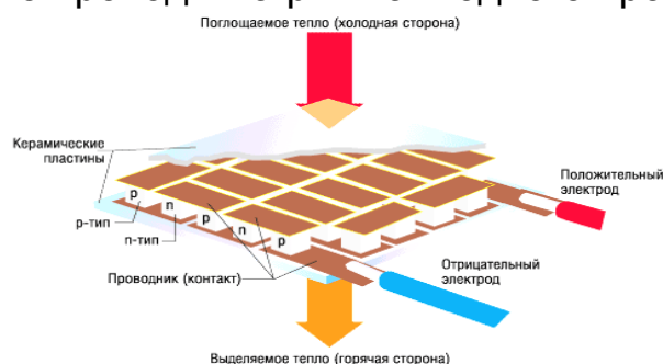
Рис.1 Принципиальная схема элемента Зеебека
